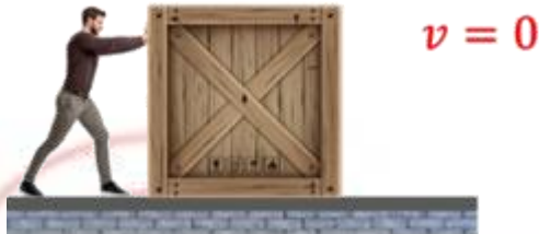
Fig. 4.11: Las superficies en contacto del bloque y el piso tienden a resbalar una sobre la otra, pero no hay deslizamiento.
