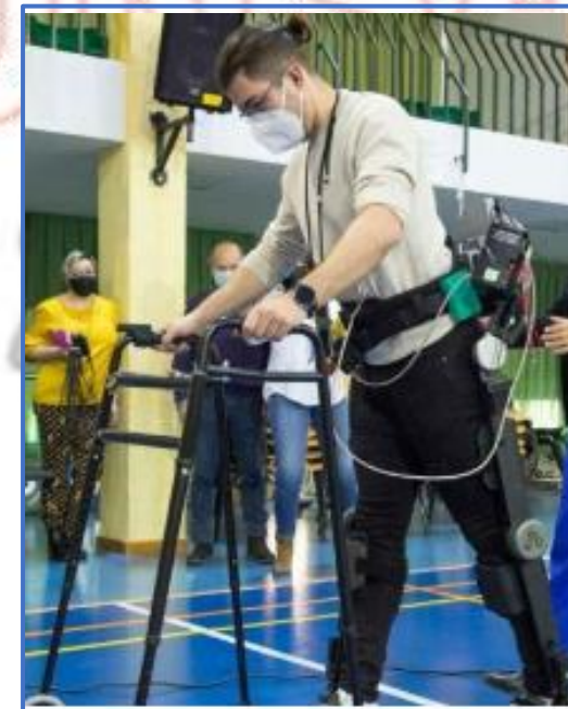
Fig. 9.1: A pesar de la insensibilidad de los pacientes con parálisis, los electrodos producen señales que logran excitar los músculos y obtener movimiento.
